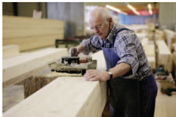
Bild 1 Oberflächenbearbeitung in einem BS-Holz-Werk
