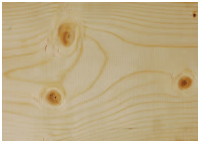
Bild 3 Querschnittsver- schwächung und örtliche Faserabweichung infolge eines Astes
