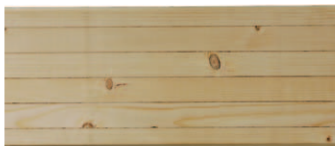
Bild 11 Gehobeltes Brettschichtholz mit lokaler Rauigkeit im Bereich eines Astes
