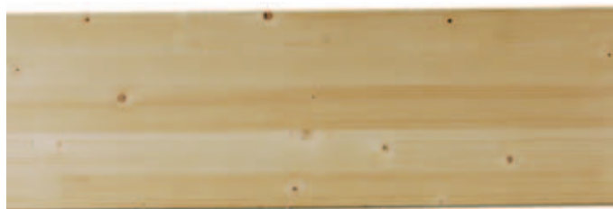
Bild 8 Mit hellem Klebstoff hergestelltes BS-Holz
