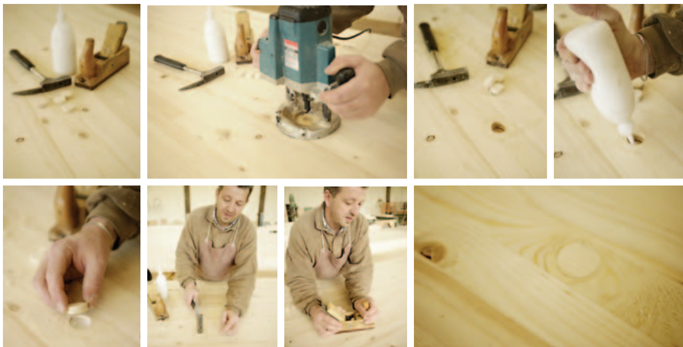
Bild 4a-h Ausbessern von Ästen durch Astlochstopfen
